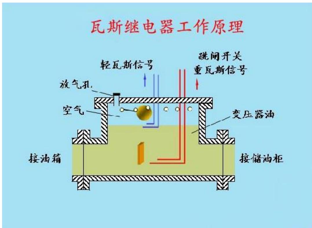
瓦斯保护是变压器内部故障的主要保护元件，对变压器匝间和层间短路、铁芯故障、套管内部故障、绕组内部断线及绝缘劣化和油面下降等故障均能灵敏动作。当油浸式变压器的内部发生故障时，由于电弧将使绝缘材料分解并产生大量的气体，其强烈程度随故障的严重程度不同而不同。瓦斯保护就是利用反应气体状态的瓦斯继电器（有称气体继电器）来保护变压器内部故障的。
